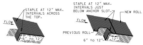
ANCHOR SLOT - INSTALL ANCHOR SLOT AT UPSLOPE END OF THE EROSION CONTROL BLANKET. STAPLE A MINIMUM OF EVERY 12" ACROSS THE TOP.
